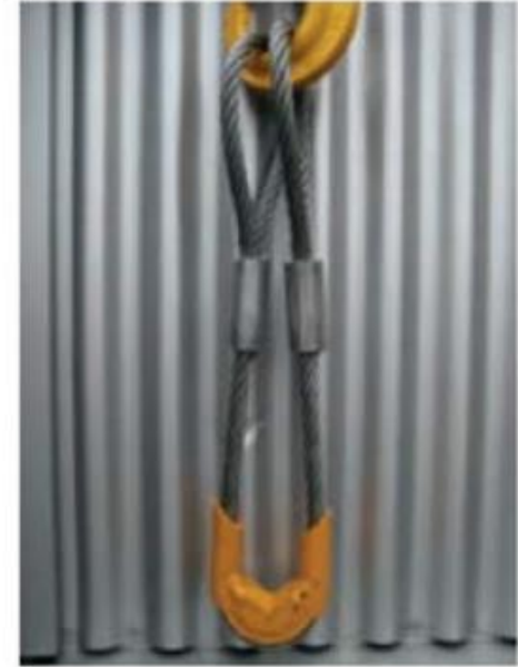
Damwandstrop met stalen beschermingskous
