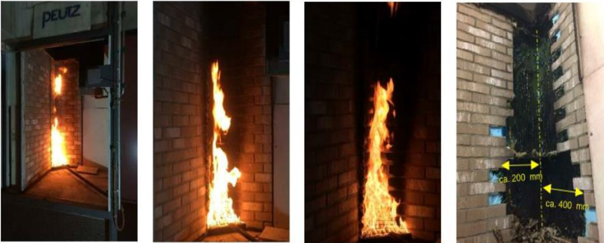
Testbeeld test 2 SBI test met spouwonderbreking van de datum 03/03/2021:
