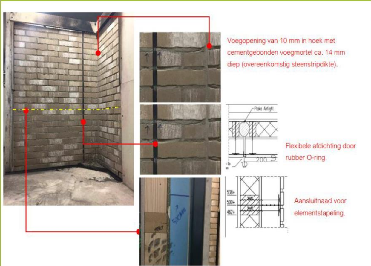
Figuur 1: Testopstelling testopbouw 1 zoals vervaardigd
