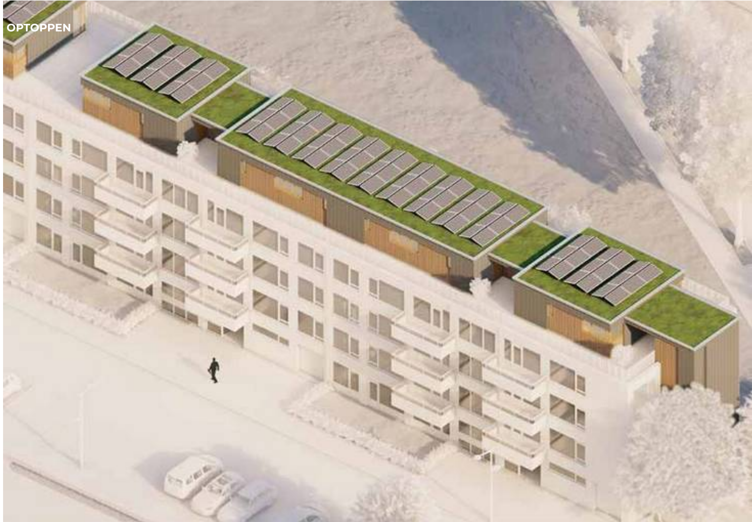
De Optopper van de Van Dillen Bouwgroep is een houten dakopbouw waarmee een naoorlogs wooncomplex van een extra woonlaag kan worden voorzien.
